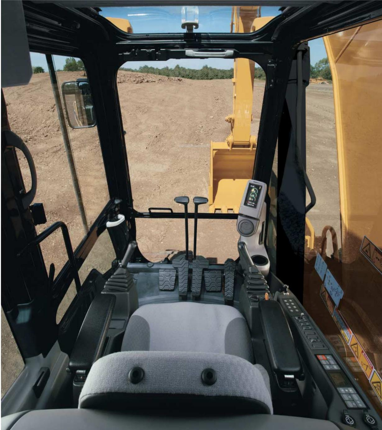
**Ruang Operator.** Ruang operator luas, tidak bising dan nyaman, memastikan produktivitas tinggi selama hari kerja yang panjang. Sakelar air conditioner dan sakelar alat pelengkap ditempatkan pada dinding sebelah kanan, dan sakelar start serta dial trotel terletak pada konsol sebelah kanan. Monitor ini mudah dilihat dan memaksimalkan penglihatan.
