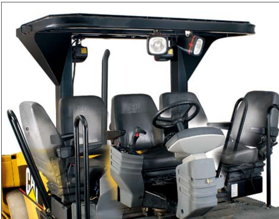
为了使 FOPS 能提供有效保护，驾驶员必须坐在顶棚下面
