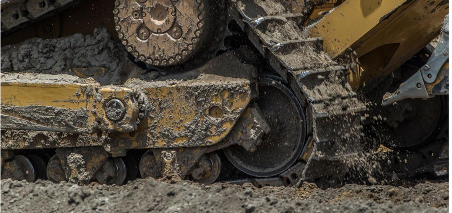
高架链轮和悬挂式底盘系统配合工作，既增加了牵引力，又使操作员驾驶更平稳。高架链轮设计可将施加至机具的振动负载传送到主机架，使终传动、轮轴和转向部件免受强烈冲击，这进而提高了生产率和延长了部件的使用寿命。
