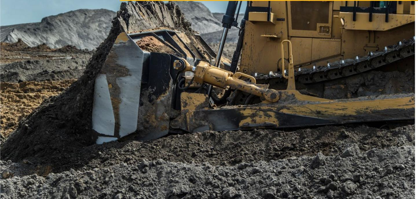
D10T2 配有经过现场验证的新型负载感应机具液压装置，它通过自动连续调节机具的液压功率来满足操作要求，因此改善了燃油效率和机器性能。由于仅在发出机具命令时才会提供液压流量，因此履带获得更多的功率来推动机器前行，提高了推土机的性能。
