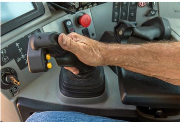
省力的电子推铲操纵手柄让操作员可以单手全面控制所有推铲功能。裂土器操纵手柄位于操作员右侧，推铲操纵手柄的正后方。稳固安装的把手可为操作员提供有力的支撑，即使在最崎岖的地面上执行裂土作业时，也是如此。
