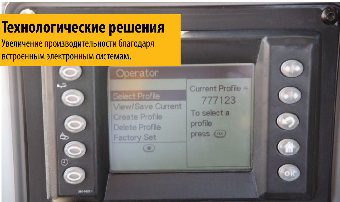
Полная интеграция электронных систем модели 854K позволяет им работать как одно целое. Эта интеграция обеспечивает "интеллектуальность" машины и увеличивает информированность оператора, что максимально повышает производительность оборудования и персонала.
