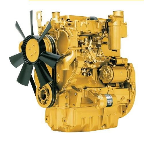
Cat® 3054C 发动机的设计符合中国 Tier 2 排放法规。此发动机采用了久经考验的机械调速器和低压燃油喷射系统,这是燃油系统耐用性得以改善、燃油效率得以提高、故障诊断与排除更加便利的主要原因。粗滤器、油水分离器以及细滤器相结合,实现更高的过滤性能,并有助于提高燃油滤清系统的可靠性。
