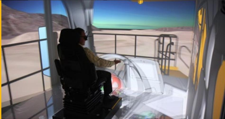
Le centre technique de Caterpillar à Mossville, dans l'Illinois (États-Unis), abrite le Centre de visualisation immersive de Caterpillar. Ce dernier se compose d'une chambre (trois murs et un plancher) de réalité virtuelle comprenant un système tridimensionnel à quatre écrans et 12 projecteurs numériques 3D haute définition. Avec son aire de travail utilisable de plus de 20' de large et 10' de hauteur et de profondeur, il s'agit là de l'un des plus grands systèmes de ce type en Amérique du Nord.
