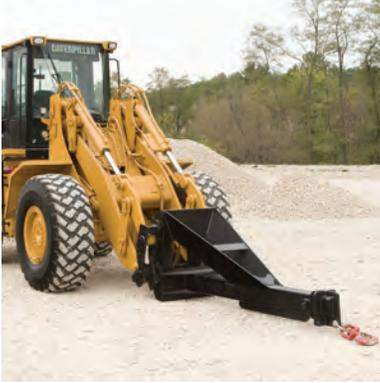
Os Braços de Manipulação de Materiais colocam com precisão dutos, blocos de concreto, divisores de estrada e outros materiais de construção rapidamente — com visibilidade e controle máximos. Eles fornecem maior rendimento se comparados com caçambas com correntes ou outros meios melhorados. Com um Braço de Manipulação de Materiais, o operador tem uma visão total da carga, do local do trabalho e de outros trabalhadores.
