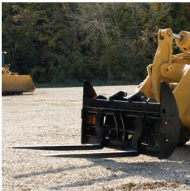
Os garfos são ferramentas essenciais em qualquer local de trabalho. Eles descarregam os caminhões, colocam material e carregam novamente.
