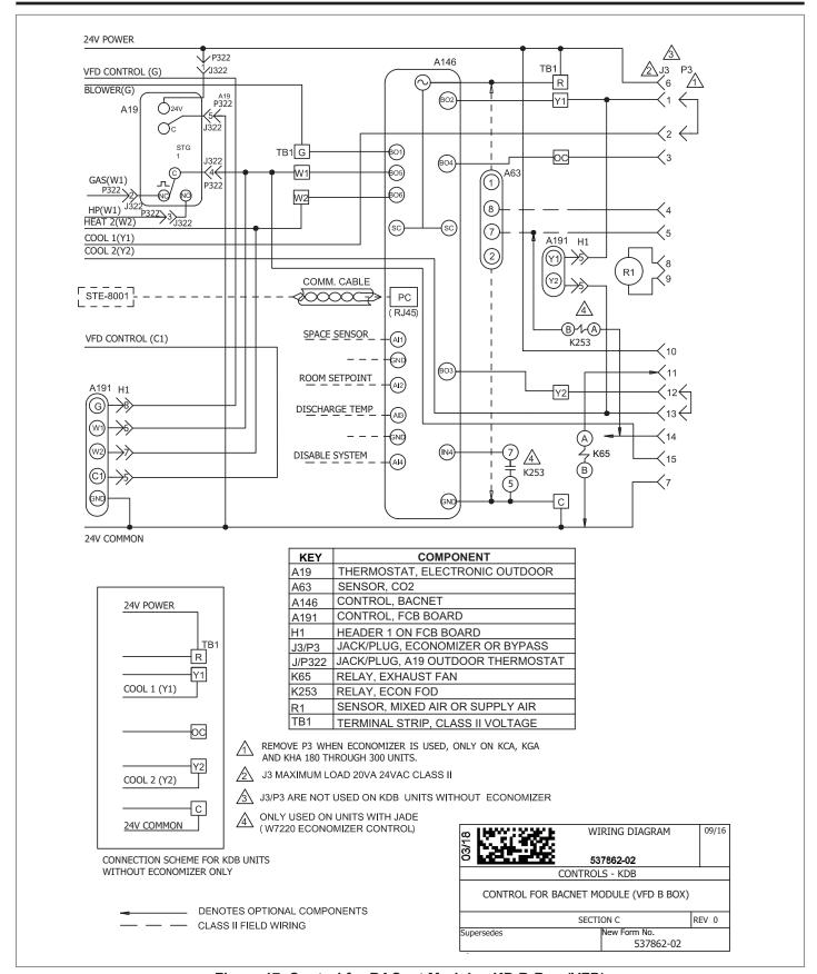
Figure 17. Control for BACnet Module - KD B-Box (VFD)
