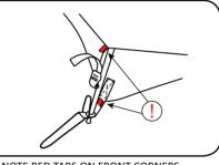
NOTE RED TABS ON FRONT CORNERS HOOK BUCKLE AROUND CORD AND PULL TO TIGHTEN
