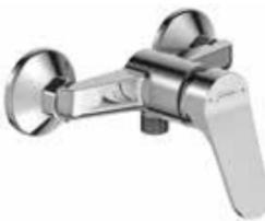
**E75766-CP Mitigeur bain-douche mural** Bague-limiteur de température. Limiteur de débit sensitif. Raccords et rosaces murales. Inverseur automatique verrouillable. ECAU : E3/1 C2 A2 U3 Ge3. Existe sur gorge : **E75768-CP**. Mitigeur compatible avec colonnettes universelles : E75466-CP.
