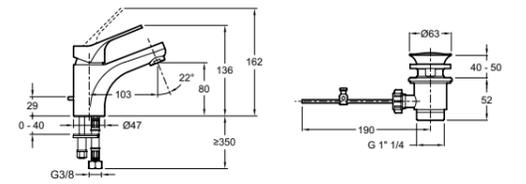
**E78111-4-CP Mitigeur lavabo avec cartouche C3** Pour des économies d'eau et d'énergie (levier centré = eau froide). Limiteur de débit sensitif. Bonde de vidage métall. Débit limité à 9 l/mn. ECAU : E0 C3 A2 U3 Ge5. Existe avec bonde de vidage métallo-plastique : **E75759-4-CP**
