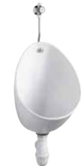
**NF E1545-00 Patio - Urinoir** 33,5 x 63,2 x 33 cm, alimentation et évacuation apparentes. Livré avec équipement complet E74192-NF : fixation E4598, effet d'eau E74203, tube E74186, bonde à grille E78166, siphon S.V. E6334.
