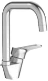
**E75769-4-CP Mitigeur bain-douche monotrou** Flexibles d'alimentation avec raccords G 3/8. Bague-limiteur de température. Limiteur de débit sensitif. Inverseur automatique verrouillable. Aérateur anticalcaire. Clapet anti-retour sur sortie douche. ECAU : E3/1 C2 A2 U3 Ge3
