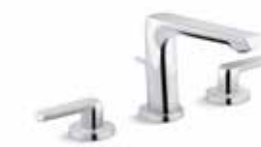
Mélangeur Lavabo - 3 trous Têtes à disques céramique Bonde de vidage en métal Débit 5 l/mn E97352-CP E97352-BN À partir de 427 € TTC
