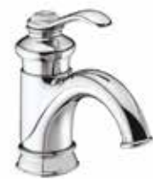
Mitigeur Lavabo Avec aérateur anticalcaire intégré Bague-limiteur de température Bonde de vidage en métal Débit 12 l/mn Hauteur 160 mm, saillie 133 mm E72090-CP - 325 € TTC
