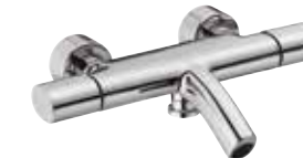
Mitigeur thermostatique bain-douche mural Inverseur automatique discret (autour de la sortie du flexible de douche) Butée de sécurité à 40°C. Température maxi inférieure à 50°C Corps tiède Clapets anti-retour sur les alimentations Aérateur anti-calcaire intégré Raccords et rosaces murales E10089-CP - 626 € TTC
