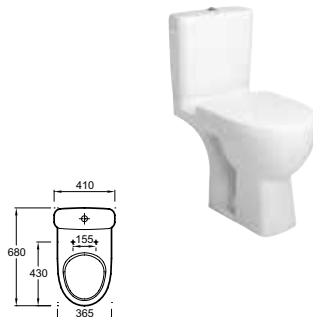
Pack WC NIF surélevé sortie horizontale, réservoir 3/6 L, avec abattant standard Alimentation latérale 68 x 36,5 cm Hauteur confort 45 cm, conforme aux réglementations PMR E0523 - 510 € TTC
