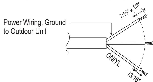
Figure 74: Power Wiring Conduit.
