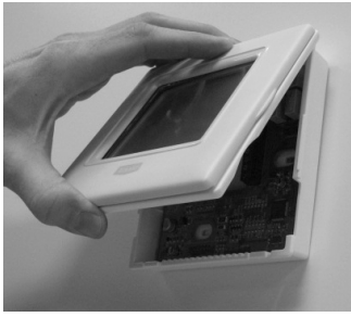
Fig. 16 - Reattach Display Module
