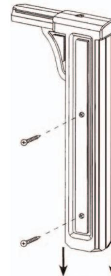
Installer un poteau 4 x 4 traité, le cas échéant. Glisser le poteau par-dessus le 4 x 4 et le fixer à l'aide de quatre vis (#6 x 4,14 cm).
