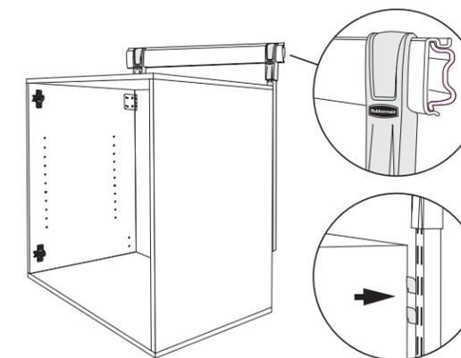
Le crochet du haut doit être inséré dans la deuxième encoche ouverte à partir de la pince sur la rangée des encoches.
