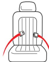
**Cinturón para la falda solamente** Dos puntos de conexión. **SOLAMENTE se puede usar en el modo arnés.**
