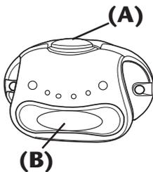
**LUCES**— Oprima una vez para encender la luz de arriba **(A)**, dos veces para encender ambas luces, tres veces para encender la luz de abajo **(B)**, y cuatro veces para apagarlas.
