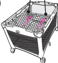
Inserte el extremo cónico de la barra en el extremo de la otra barra que tiene un agujero. Repita el procedimiento con el otro juego de barras
