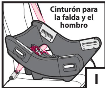
1. Saque el **LATCH** del lugar de almacenamiento **A**. Para facilitar la instalación, extienda el **LATCH** hasta el máximo.
