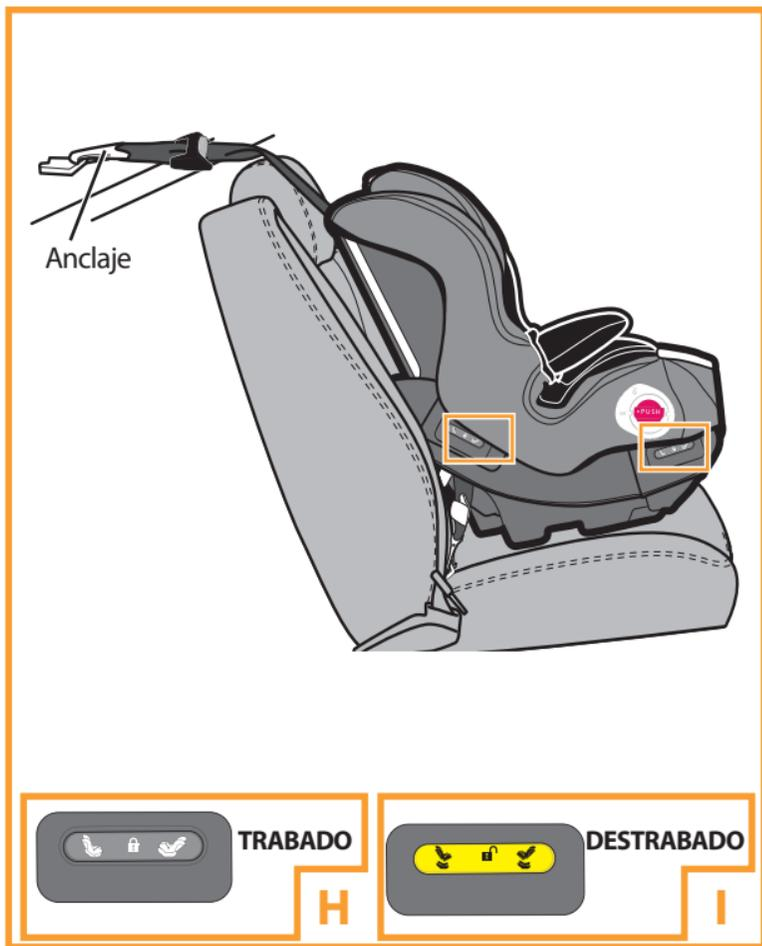
Todas las posiciones del asiento **LATCH** tienen puntos de anclaje. Use siempre el anclaje si el vehículo tiene anclajes disponibles en el modo orientado hacia adelante con el arnés. Consulte el manual del propietario de su vehículo para determinar la ubicación de los anclajes. Si su vehículo no está equipado con un sujetador del anclaje, podría ser posible instalar uno. Contacte al concesionario de su vehículo para determinar el lugar correcto del sujetador y su instalación.
