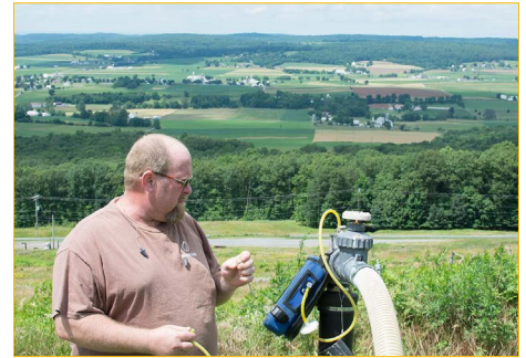
El gas metano se obtiene mediante un tubo de pozo perforado y un sistema de recolección, y se transforma de manera gradual en gas apto para gasoductos.
