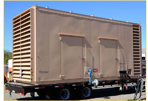
El Grupo Electrónico G3412 Cat® de 400 kW de Suburban Propane se encuentra en un contenedor móvil, que se traslada hasta cierto punto y se conecta al edificio cuando necesario.
