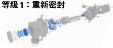
重新密封泵是成本最低的選項。利用代理商的快速處理維修或訂購 DIY 套件來修復未損壞的組件。
