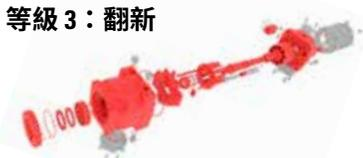
當您有較舊和磨損的組件時，翻新是合適的選擇。它保留了可使用的零件以提高成本效益，也包含最新工程技術以提供宛如新品的成效。
