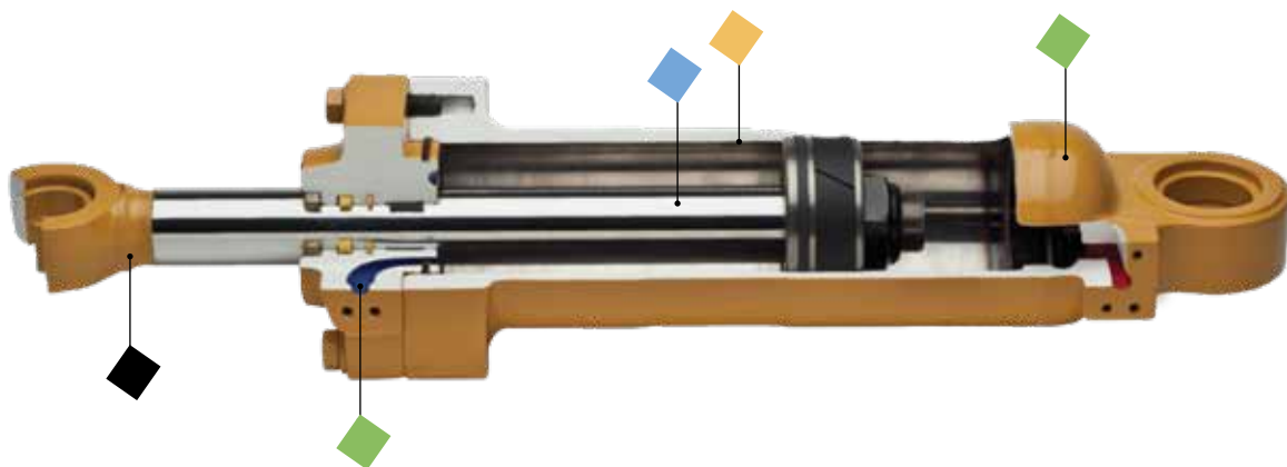
◆ OJO DE VARILLA ◆ TAPA Y JUNTAS ◆ VARILLA DE PISTÓN ◆ CAMISA DE TUBO DE CILINDRO
