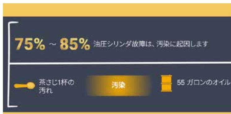
汚染コントロールは、健全な油圧システムを維持するための重要な部分です。引っかき傷、穴開き、へこみによるシリンダロッドの表面の損傷によって汚染が入り込みやすくなり、コストのかかる修理や効率の悪化につながります。定期的なメンテナンスと点検を実施することにより、潜在的な油圧システムの問題を積極的に管理できるようにします。さらに、何らかの損傷を確認した場合、最適な修理オプションの選択は必須です。最適なソリューションを採用することで、今後の汚染のリスクを減らし、油圧システムを健全な状態に維持し、時間と費用を節約できます。
