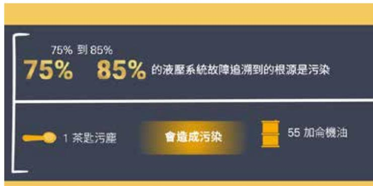
污染控制是維持液壓系統健康運轉的關鍵部分。由刻痕、點蝕或凹痕造成的油缸連桿表面損壞通常是污染物的侵入點，導致成本高昂的維修和效率降低。定期執行保養和檢查有助於主動控制潛在的液壓系統問題。此外，如果發現任何損壞，選取正確的維修選項非常重要。若能選擇正確的解決方案，則可以降低進一步污染的風險，保護液壓系統的完整性，並節省時間和資金。
