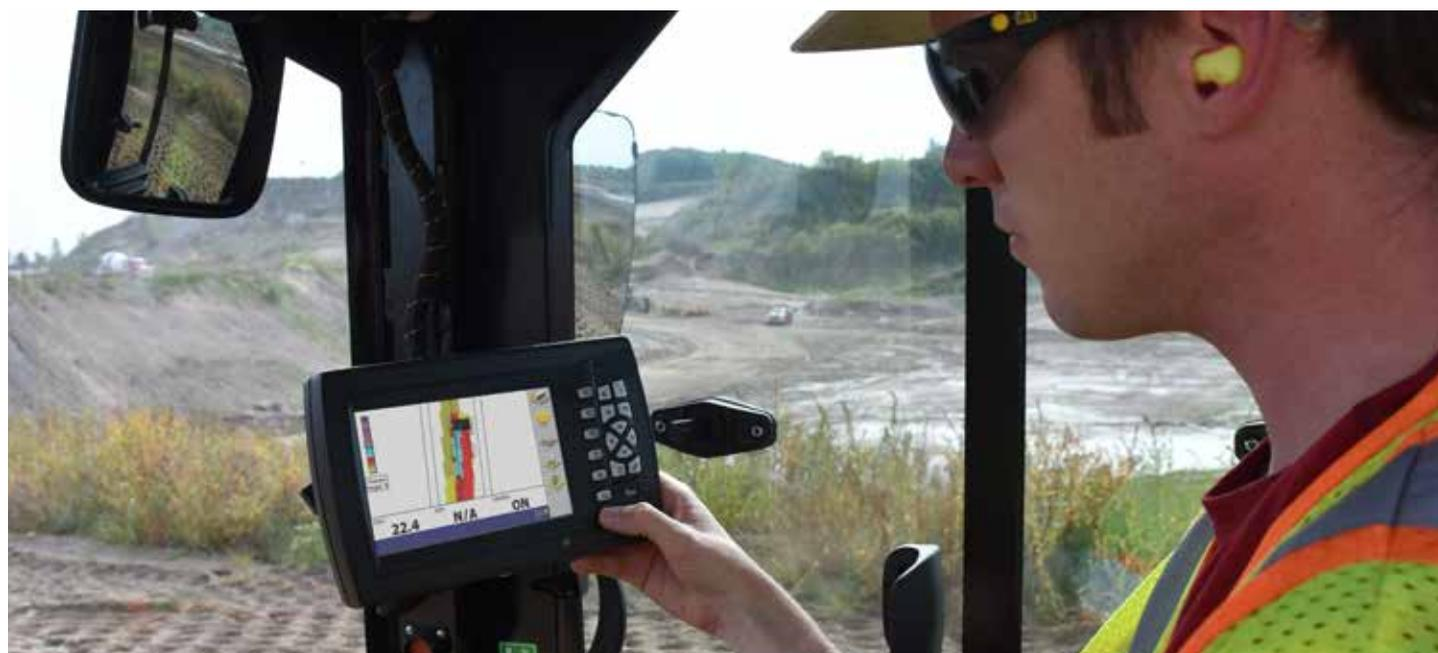
Cat COMPACT est un ensemble de technologies qui aide les conducteurs à effectuer le compactage conformément aux spécifications avec plus de cohérence, d'uniformité et d'efficacité que ne permet la simple intuition humaine. La technologie Cat COMPACT est facile à utiliser, polyvalente et évolutive, ce qui permet d'adapter votre solution pour répondre à vos besoins actuels et futurs.
