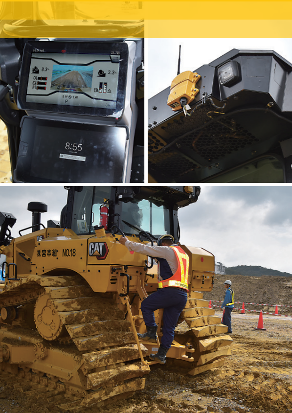
車両後部には折り畳み式はしごが装備され、燃料の補給やリアガラスの清掃などのメンテナンスも安全に行えます。
