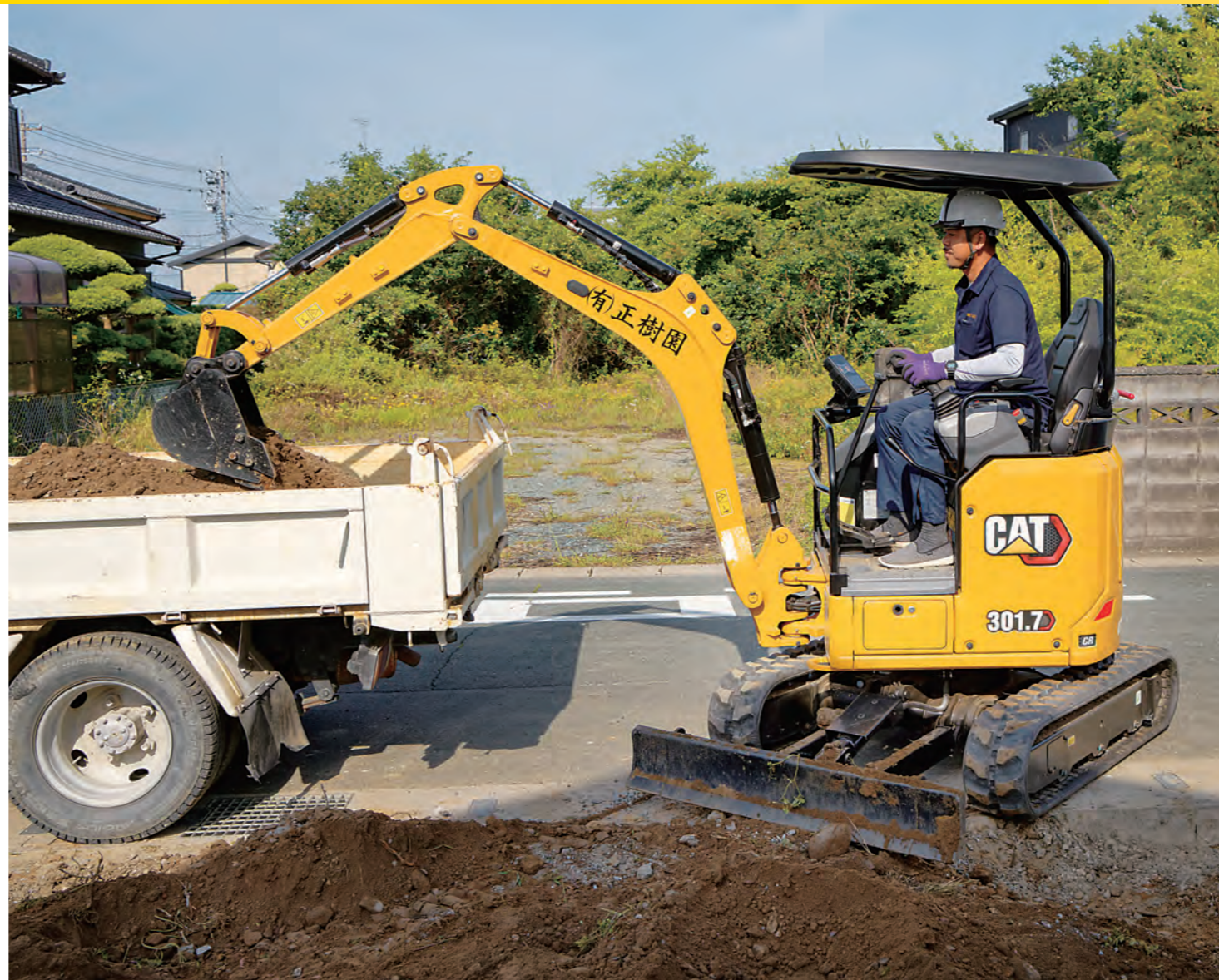
走行操作がラクなスティックステアや各種設定がタッチ操作で行える液晶モニタなど、オペレータを支援する新機能を盛り込んだ301.7CR。内蔵式の油圧ホース、背面配置のブームシリンダなど、深掘りやトラック積み込み時の接触・破損を防ぐ工夫も取り入れています。
