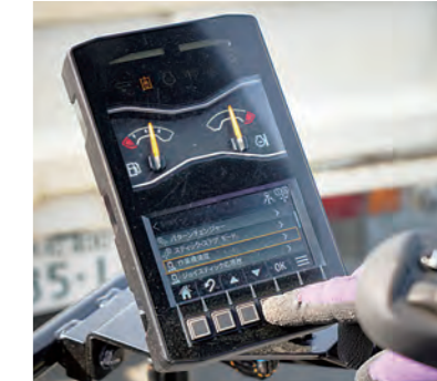
走行操作がラクなスティックステアや各種設定がタッチ操作で行える液晶モニタなど、オペレータを支援する新機能を盛り込んだ301.7CR。内蔵式の油圧ホース、背面配置のブームシリンダなど、深掘りやトラック積み込み時の接触・破損を防ぐ工夫も取り入れています。
