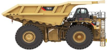
797F 鉱山用トラックは、Caterpillarが製造する最大のトラックです。このトラックは、銅、石炭、金、鉄鉱石などのさまざまな資材を運搬するために、世界の多くの地域の鉱山現場で使用されています。797Fの高さは25フィート4インチで、長さは49フィート6インチです。トラックの重量は1,375,000ポンドで、400トンの積載量です。最高速度は、42mphです。
