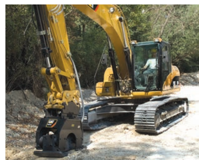
Plaque de compacteur : Plaque de compactage pour pelle
