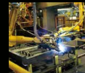
最新鋭の溶接ロボット4台を配した、スイングフレームFMS
