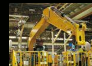
オーダーの仕様に合わせて、ブーム/スティックがスピーディーに装着される
