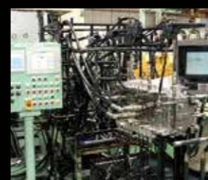
組立を終えたコントロールバルブの品質検査を行うテストスタンド
