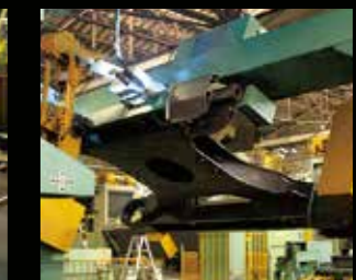
ツイン溶接ロボットを駆使して強固なベースフレームを高速生産
