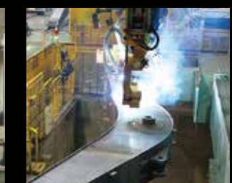
高速タンデムアーク溶接を用いて強固なブームを生産
