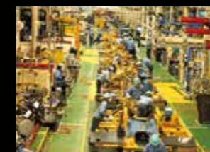
全長200メートルのメイン組立ラインは機種に応じて搬送間隔を自在に変更可能
