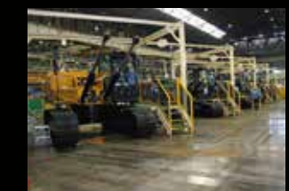
性能試験場では完成車を1台1台コンピュータ制御の試験台でチェック
