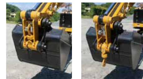
ラッチ格納式吊りフック フックの出し入れがワンタッチで簡単に行えるラッチ格納式を採用しています。
