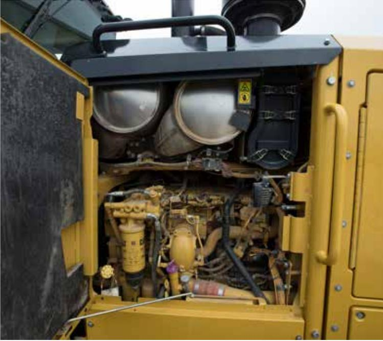
La tecnología de reducción de emisiones de las motoniveladoras 140/150/160 está diseñada para ser transparente, sin necesidad de que el operador realice acción alguna. No es necesario detenerse. La regeneración se realiza automáticamente en arranque frío y, si es necesario, en segundo plano mientras trabaja.
