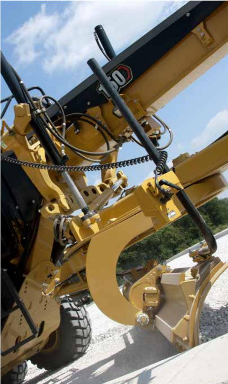
Caterpillar diseña los componentes de la barra de tiro y bastidor de la motoniveladora con el objetivo de asegurar el rendimiento y la durabilidad. El círculo de acero forjado de una sola pieza soporta cargas de gran esfuerzo y el sistema de protección contra el desgaste contribuye a reducir los tiempos de servicio y mantener los costes bajos.
