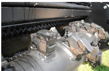
Dents en carbure retenues par un seul boulon
