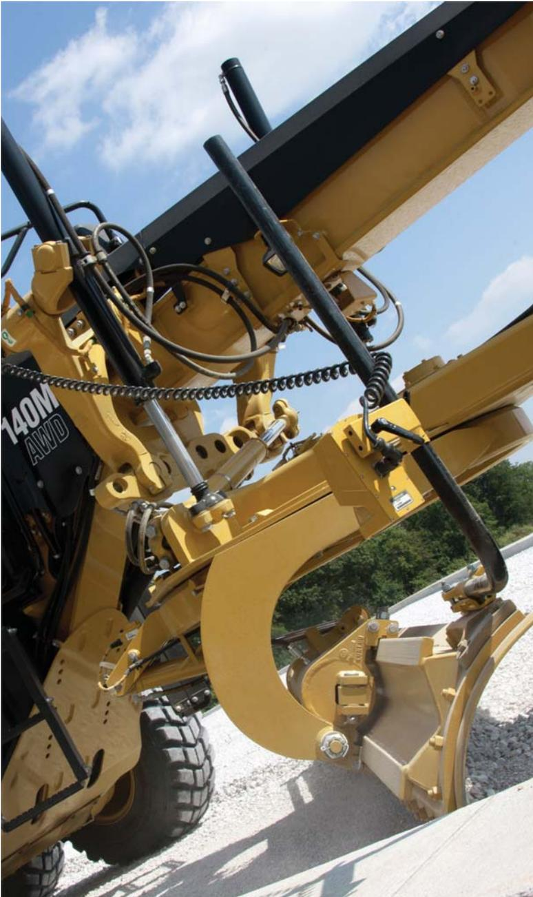
Il telaio del motorgrader e i componenti della barra di traino Caterpillar sono stati progettati per fornire massime prestazioni e durata. La ralla monolitica in acciaio forgiato è costruita per resistere a sollecitazioni elevate e un sistema antiusura mantiene i costi e i tempi di manutenzione estremamente bassi.
