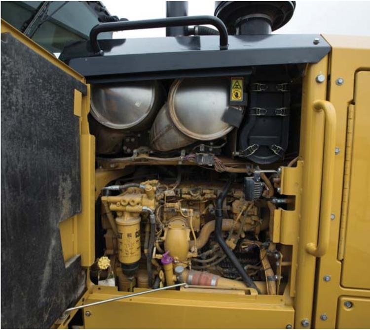
La tecnologia di riduzione delle emissioni sui motorgrader della Serie M3 è stata progettata per essere trasparente, non richiedendo alcuna azione da parte dell'operatore. Non è necessario fermarsi, la rigenerazione viene infatti eseguita automaticamente all'avviamento a freddo e, se necessario, in background mentre si lavora.
