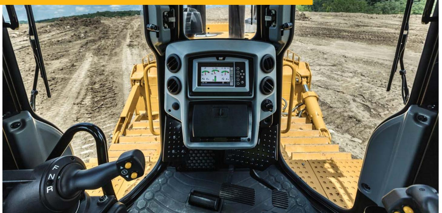
Kabin yang tenang dan nyaman, dengan Struktur Pelindung Bahaya Terguling (ROPS, Roll Over Protection Structure), memberi operator visibilitas yang lebih luas ke area sekeliling untuk meningkatkan keselamatan dan produktivitas. Tekanan udara membantu menyingkirkan debu agar lingkungan pengoperasian menjadi lebih bersih. Gagang gaya tiller tunggal yang mudah digerakkan mengontrol arah dan pilihan roda gigi untuk memudahkan pengoperasian.
