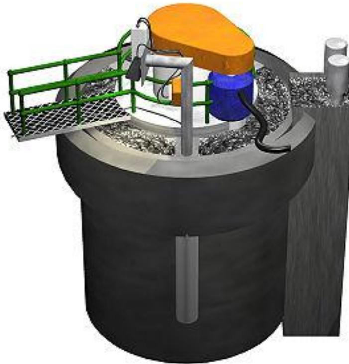
Figura 1: tanque de flotación por espuma
