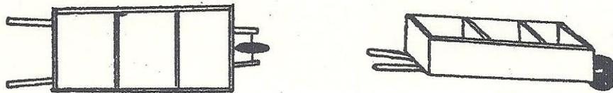
2. Con un dinamómetro, pese el objeto que está utilizando para representar la carga. Luego añada el objeto a la sección de la carretilla que esté más cerca de las manijas. Coloque un dinamómetro en las manijas y levante la carretilla para determinar la fuerza ejercida para levantar la carga.
