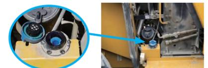
燃料タンクを充填した場合は、尿素水タンクも充填してください。尿素水タンクのキャップは青色で、燃料タンクのキャップの横に配置されています。尿素水タンクに間違えて燃料を充填しないように注意してください。
