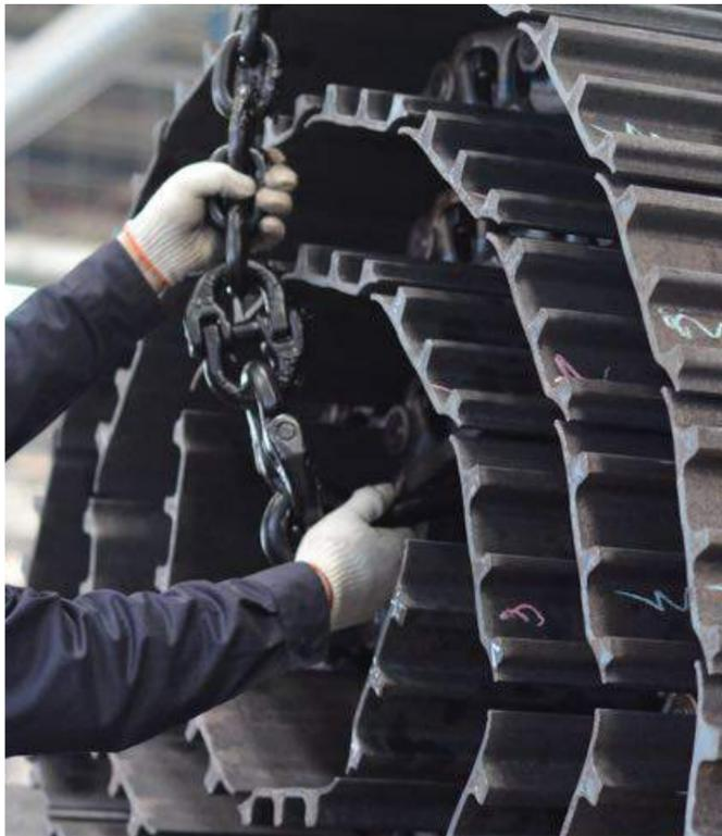
机械制造过程中，员工需要经常用手接触大型工件，这对手部安全构成很高的隐患。为降低员工手部安全风险，卡特彼勒在中国的各个工厂都制定了保护手部安全的特别措施。其中，卡特彼勒（青州）有限公司（以下简称“青州工厂”）是一个突出的例子。该工厂拥有300余台起重机，1100多套吊具，70%的员工在工作中需要接触吊装操作。青州工厂从2014年开始推行“第11根手指”的手部安全防护项目，为员工配备不同类型的手操作辅助工具，保证员工与工件保持安全距离，帮助员工完成风险较高的吊装操作，充分保护员工手部安全。2016年，该厂扩大了“第11根手指”的使用范围，目前七大类、135根手指工具正在广泛使用。为确保员工能够正确、有效地使用手指工具，工厂还制作了使用规范要求和可视化图片指导。同时，青州工厂也在不断对该项目进行升级，采用材质更轻的材料制作手指工具，使手指工具更方便使
