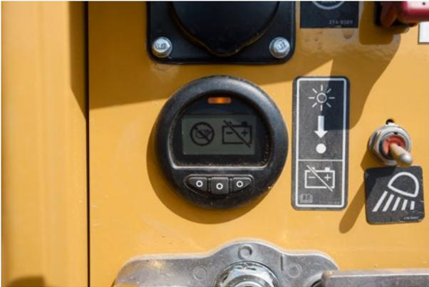
Die Technologie zur Emissionsminderung ist so konzipiert, dass sie transparent ist – die Regenerierung erfolgt während der Arbeit automatisch im Hintergrund. Abgasreinigungsflüssigkeit (DEF, Diesel Exhaust Fluid) kann bequem beim Tanken aufgefüllt werden.
