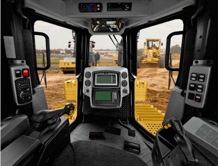
Der Fahrer genießt zusätzlichen Komfort wie eine leise Fahrerkabine, einen optionalen beheizbaren/belüfteten Sitz und einen zusätzlichen Stromanschluss. Das Hauptdisplay und das Grade Control-Display befinden sich direkt vor dem Fahrer, der gleichzeitig ausreichend Sicht über die Motorhaube genießt.
