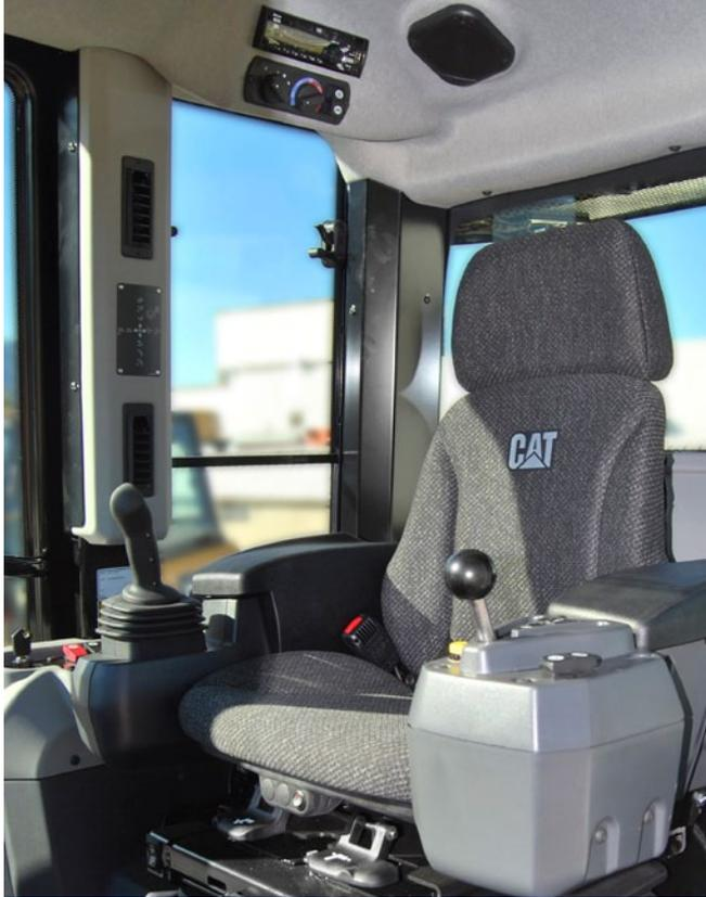
Gli operatori usufruiscono anche di un più elevato livello comfort nella cabina aggiornata, grazie ad esempio ai braccioli e ai comandi regolabili manualmente, all'impianto di climatizzazione migliorato e all'opzione sedile riscaldato/ventilato. La nuova interfaccia operatore a cristalli liquidi consente di personalizzare in modo semplice le prestazioni della macchina e di visualizzare le relative informazioni operative e di manutenzione.
