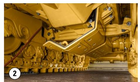
Rechts – Angetriebener Bodenschutz
