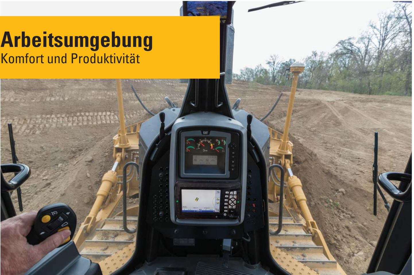
Die Fahrerkabine des D7E ist ruhig und geräumig. Die Mittelsäulenkonstruktion bietet hervorragende Sicht auf die gesamte Maschine, und verhilft dem Fahrer so zu mehr Sicherheit bei der Arbeit. Außerdem kann der Fahrer zusätzlichen Komfort wie manuell einstellbare Armlehnen und einen Sitz mit Heizung/Belüftung genießen.
