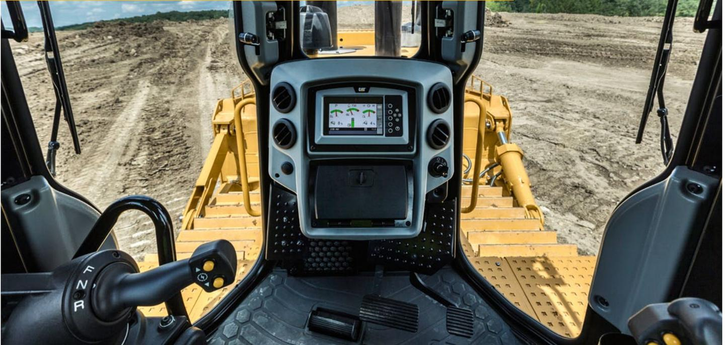
Calme et confortable, la cabine équipée d'un cadre de protection en cas de retournement (ROPS, Roll Over Protection Structure) intégré offre au conducteur une meilleure visibilité panoramique pour améliorer la sécurité et la productivité. La pressurisation permet d'empêcher la pénétration de poussière, pour un environnement de travail plus propre. Une seule commande de type poignée et très maniable contrôle la direction et la sélection des vitesses, pour une utilisation plus facile.
