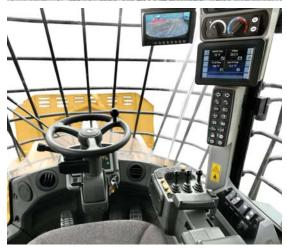
Ein Hauptziel bei der Gestaltung der Radlader 950M und 962M bleibt die Verbesserung der Fahrereffizienz. Der Fahrer muss sich sicher fühlen, die Steuerung der Maschinen sicher beherrschen und sich in einem sauberen, bequemen und ruhigen Arbeitsbereich befinden, in dem er durch intuitive und leichtgängige Bedienelemente lange konzentriert und effizient arbeiten kann.
