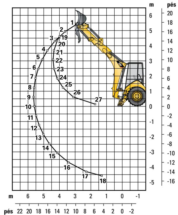
As Capacidades de Levantamento têm valores excedentes. Máquina equipada com tração nas 4 rodas, OROPS, caçamba de propósito geral de 0,76 m³ (1 yd³) e sem contrapeso. O braço extensível inclui contrapeso de 460 kg (1.015 lb).
