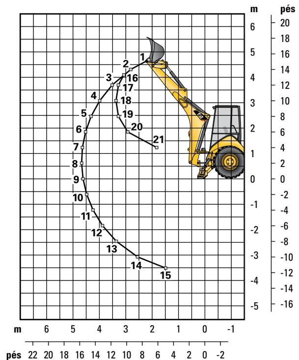
As Capacidades de Levantamento têm valores excedentes. Máquina equipada com tração nas 4 rodas, OROPS, caçamba de propósito geral de 0,76 m<sup>3</sup> (1 yd<sup>3</sup>) e sem contrapeso. O braço extensível inclui contrapeso de 460 kg (1.015 lb).
