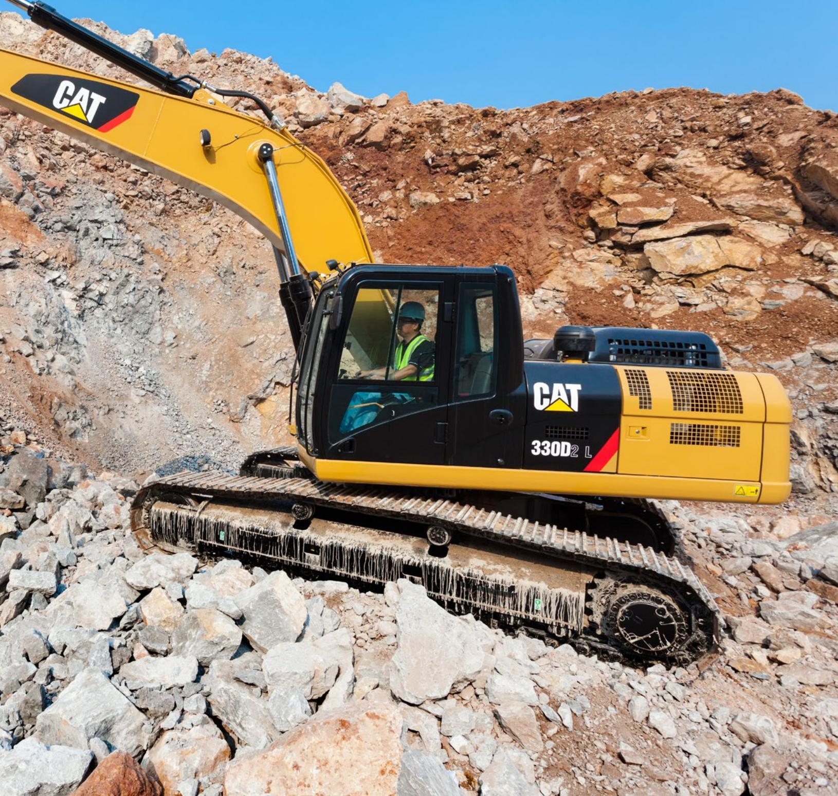
Cat 330D2 I hadir dengan berbagai pengembangan dan fitur baru, termasuk kontrol kecepatan engine, sistem filtrasi bahan bakar baru, dan mode ekonomis terintegrasi untuk membantu menurunkan konsumsi bahan bakar hingga 15 % (jika dibandingkan dengan 329D L, setara EPA Tier 2 AS, Stage II UE). Kipas kecepatan variabel dengan kopling rekat mengurangi kebisingan dan menghemat energi.
