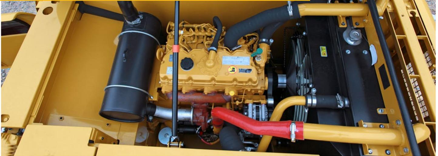
O motor Cat C4.4 ACERT com quatro cilindros foi projetado para atender aos padrões de emissões equivalentes ao Tier 3 do EPA dos EUA/ Estágio III da UE e Estágio III Fora-de-Estrada da China. O motor C4.4 ACERT de qualidade comprovada incorpora componentes resistentes e manufatura precisa com os quais você pode contar para uma operação confiável e eficiente. Menos sensível ao combustível de baixa qualidade, apresenta maior confiabilidade, ao mesmo tempo que reduz o consumo de combustível.
