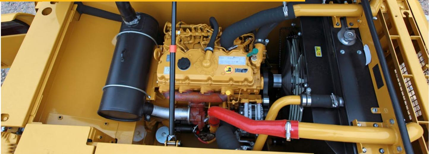
Engine Cat C4.4 ACERT dengan empat silinder telah dirancang untuk memenuhi standar emisi setara EPA Tier 3 AS, Stage IIIA UE, dan Cina Stage III Non-Jalan Raya. Engine C4.4 ACERT yang telah teruji menggunakan komponen yang tangguh dan manufaktur presisi yang dapat Anda andalkan untuk operasi yang andal dan efisien. Lebih toleran terhadap bahan bakar berkualitas rendah, engine ini meningkatkan keandalan sekaligus menawarkan konsumsi bahan bakar yang lebih rendah.
