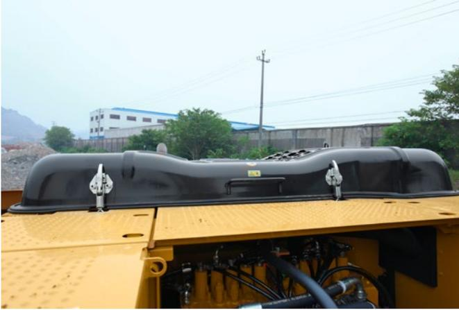
Un **plaquage métallique antidérapant** recouvre la totalité de la tourelle et du coffre de rangement afin de prévenir tout risque de glissade lors des interventions d'entretien. L'ajout de boulons à tête fraisée destinés à réduire les risques de trébuchement renforce la sécurité de l'ensemble.
